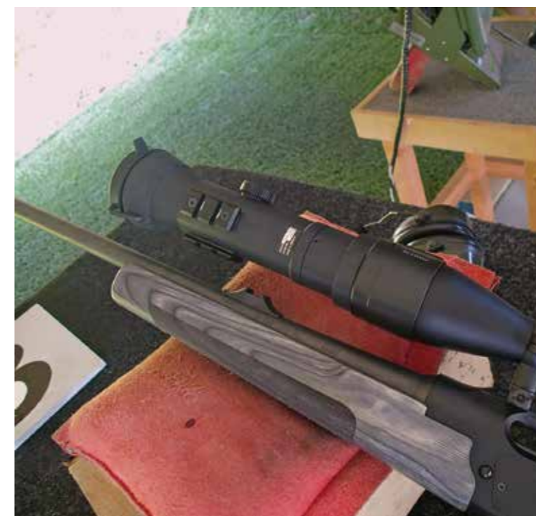
Dedal warmtebeeld voorzettercamera op een Strasser RS14 buks.
